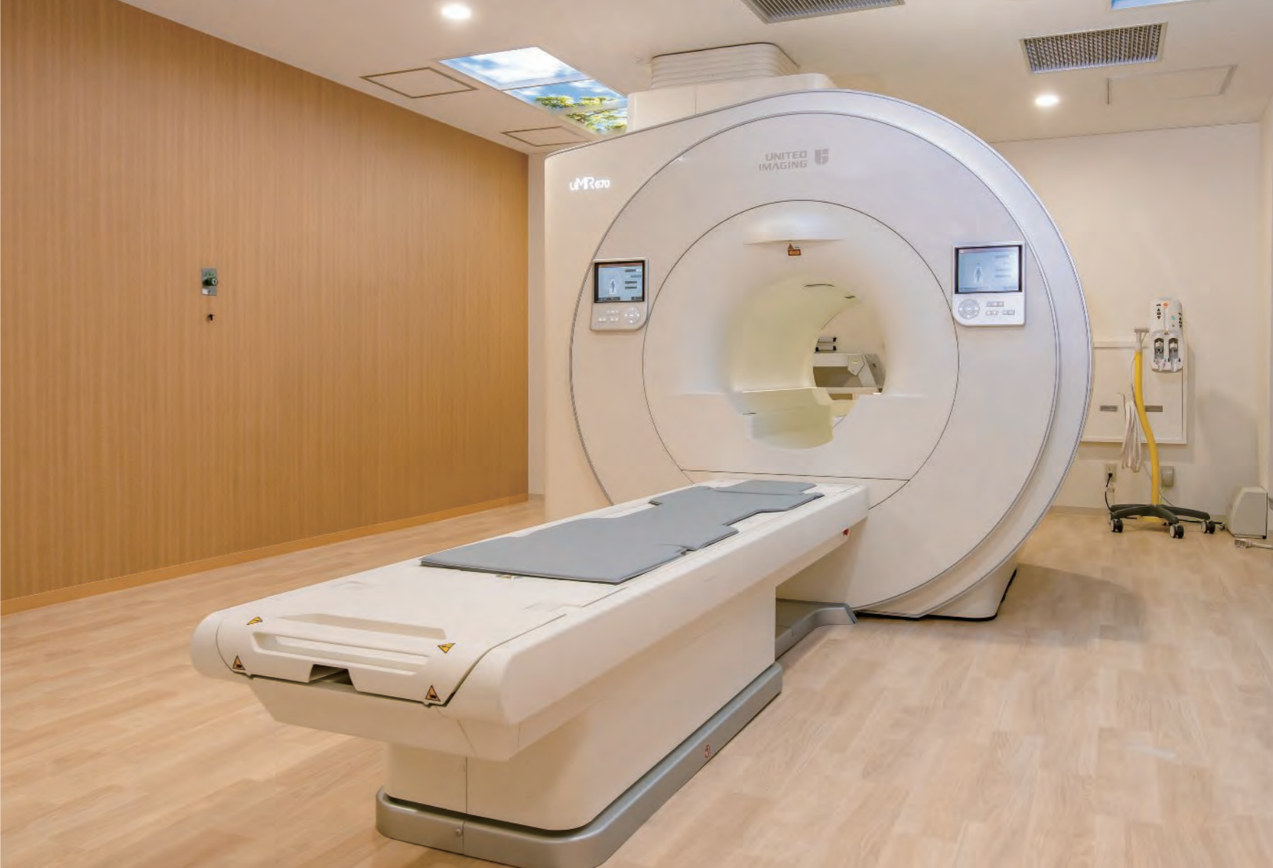
2024年9月に稼働を開始した高性能1.5T MRI「uMR670 (United Imaging Healthcare)」。AI技術を活用した画像再構成技術など、多彩なアプリケーションと撮像技術を有する装置として、大船中央病院のMRI検査を支えている。なお、同装置は国内1号機である。
