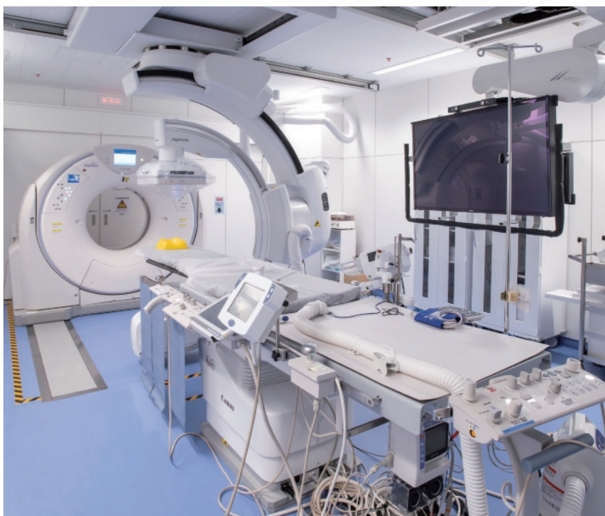
自走式80列マルチスライスCT「Aquilion Prime SP (キヤノンメディカルシステムズ)」と血管撮影装置「Alphenix (同)」を組み合わせたハイブリッドERを初療室に設置。CTは自走式で2部屋型のものを採用、一般診療の検査にも活用できるようにしている。
