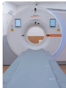
DSCTの冷却方式を採用し、チャージの設置が不要。同CTはエネルギー消費電力も20%減となり、性能も優れる。X線発生装置がガトリウム型となり、設置面積は[SOMATOM Drive]より31%減と省スペース性能も優れている。
