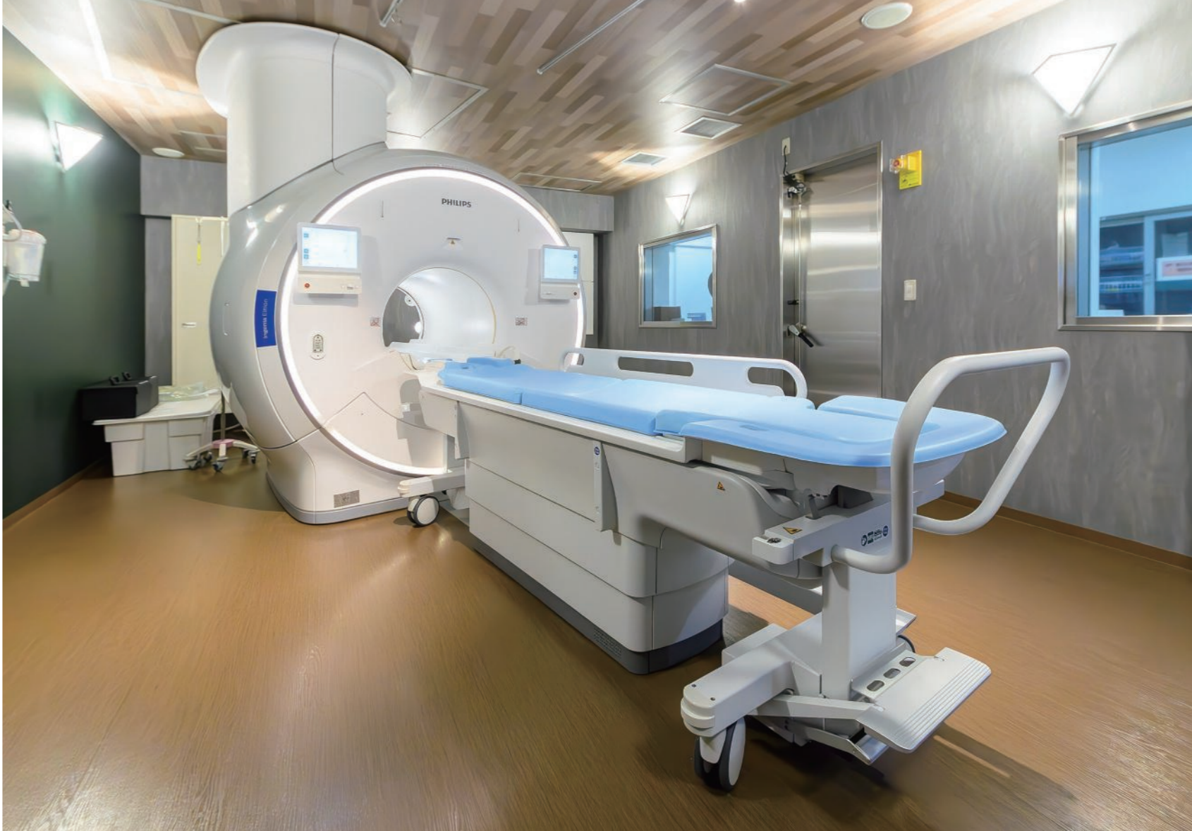
2024年3月に稼働を開始したフィリップス製3.0テスラMRI「Ingenia Elition 3.0T X」。高速撮像アプリケーション「SmartSpeed」をはじめ、AIを活用してMRI検査の高画質化・高効率化を実現している。
