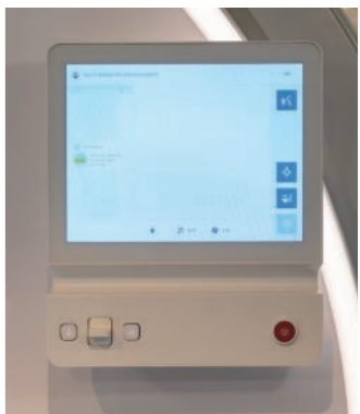
「Ingenia Elition 3.0T X」に装備された「VitalScreen」。12インチのタッチスクリーンを介して、患者の体位やVCGセットアップ、造影剤使用の有無や呼吸同期システム「VitalEye」の情報を表示、検査情報を検査スタッフが容易に把握できる。
